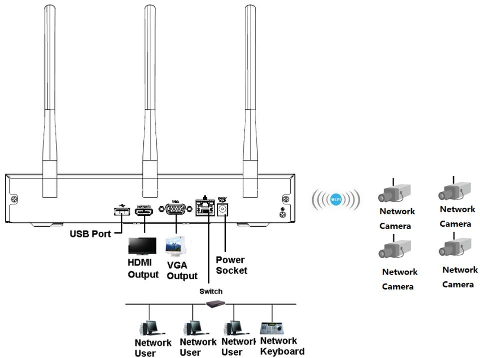
**3.5.3 NVR11HS-S3H/NVR11HS-P-S3H/NVR11HS-8P-S3H/NVR41HS-4KS2/NVR41HS-P-4KS2/NVR41HS-8P-4KS2/NVR41HS-4KS2/L/NVR41HS-P-4KS2/L/NVR41HS-8P-4KS2/L/NVR21HS-4KS2/NVR21HS-P-4KS2/NVR21HS-8P-4KS2/NVR21HS-I/NVR21HS-I2/NVR21HS-P-I/NVR21HS-P-I2/NVR21HS-8P-I/NVR21HS-8P-I2/NVR21HS-S3/NVR21HS-P-S3/NVR21HS-8P-S3 Series**
